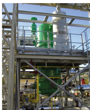
Infrastruttura di ricerca pilota ZECOMIX (a destra il reattore di carbonatazione)
