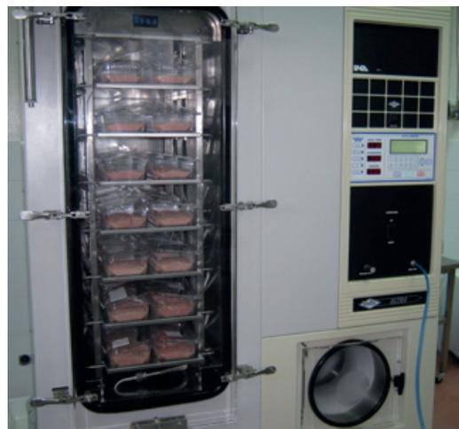
1) Impianto di evaporazione sotto vuoto STRIKE 5000 e 2) Impianto di Liofilizzazione in scala pilota VIRTIS Genesis 35s presso il CR Trisaia (MT)
