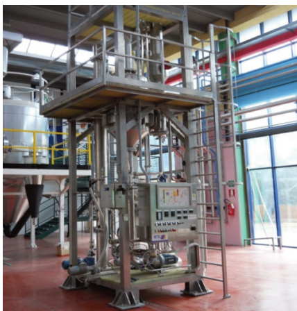
Impianto di evaporazione a film cadente Hall Tecnologica Agrobiopolis del CR Trisaia (MT)
